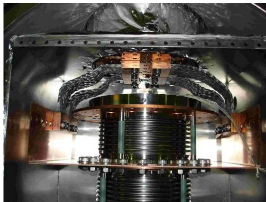
図 11 液体窒素溜めと HOM ダンパー試作機をブレード線で接続
