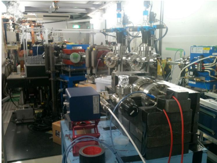
図5：ビームラインに設置した MCP 検出器
