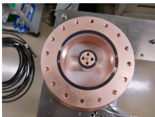
図 2-5 改良 cold 窓(写真)。
