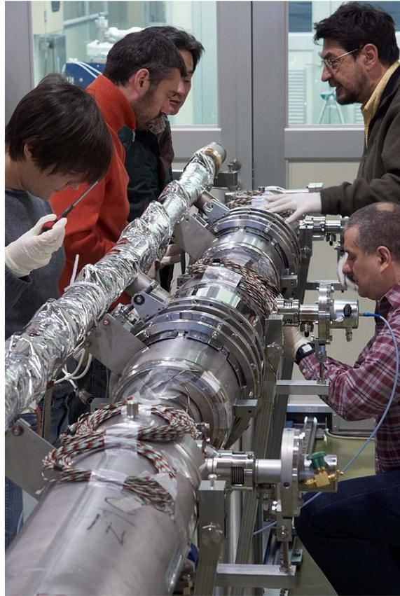
図4：ブレードチューナーとサクレ型チューナーの空洞への取付を行なっているところ。ピエゾチューナーの動作原理がそれぞれ異なっており、その性能比較により、よりよいチューナーの開発を行なう事ができる。
