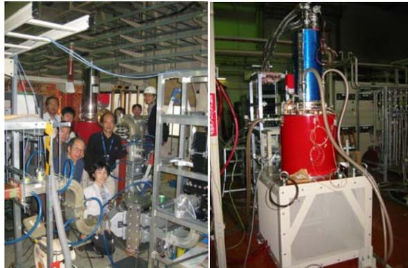
図 11 : 写真左は KEK で据付。手前にサーキュレータがある。写真右はクライストロンアセンブリ単体の写真。
