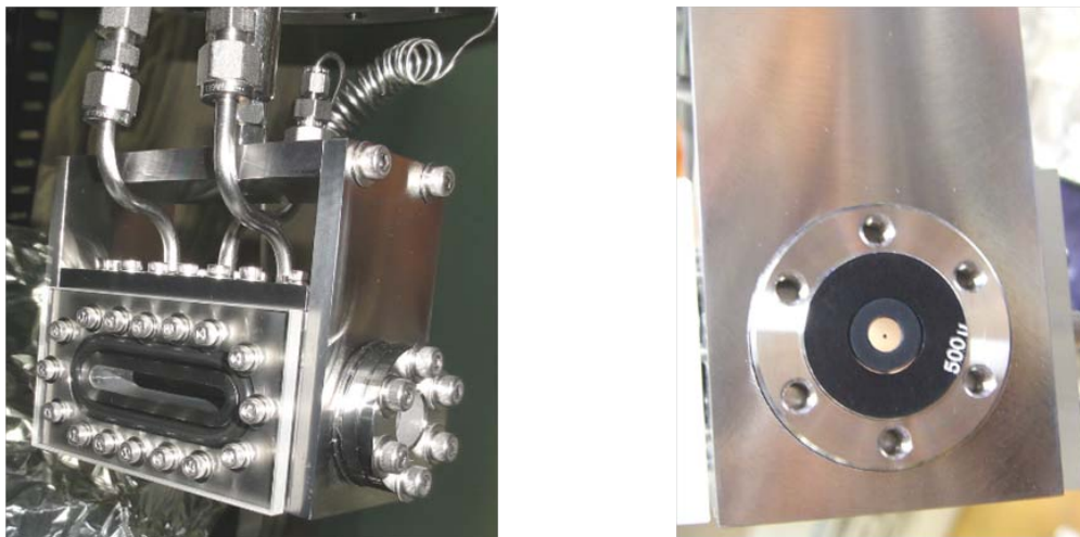
図3 ガスセル装置 右図はピンホール付近
