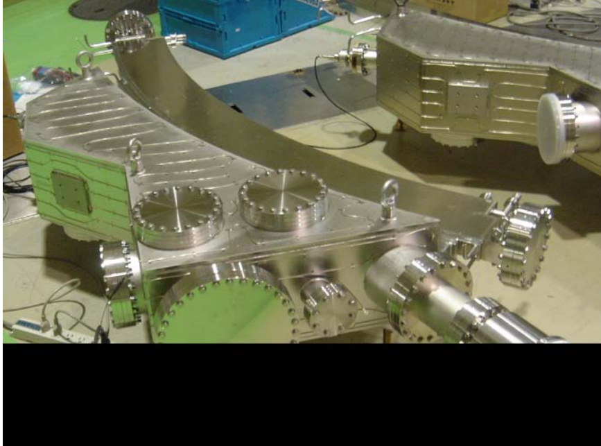
図 7. テラヘルツ集光ミラー設置のための特殊形状偏向ダクト
