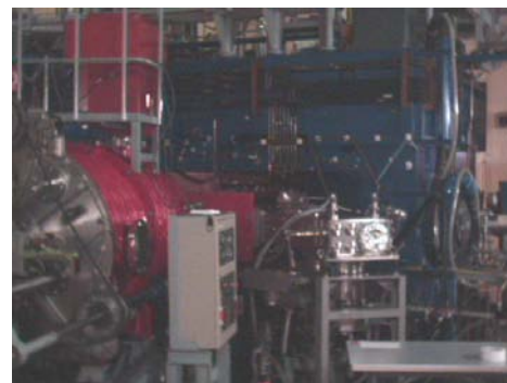
図1 赤外線サーモグラフィーによるサイクロトロン鉄芯温度測定例（上図）。下図は測定部分の写真。
