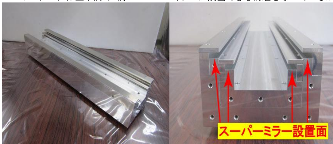
図 2-3. KB ミラー実験装置の中性子集束機構。
