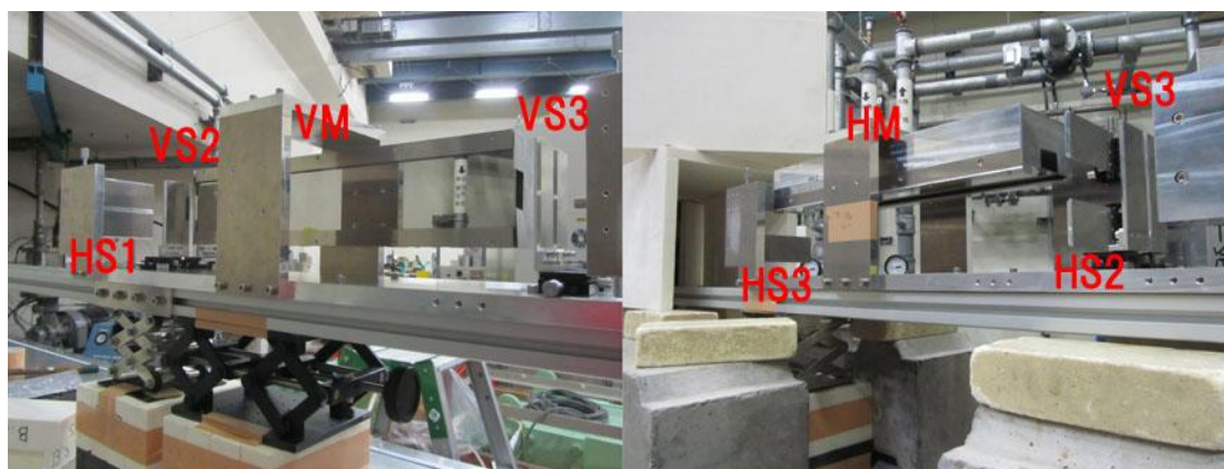
図 2-5. スーパーミラーとスリットの実験セットアップ写真。左の図は横向きに置かれた中性子集束ミラー（VM）を下流側から撮影したもの、右の図は下向きに設置された集束ミラー（HM）を上流側から撮影したものである。
