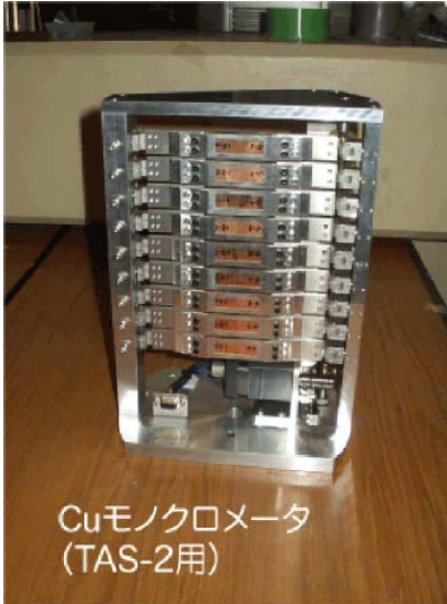
図4、縦集光可変Cuモノクロメータ。
