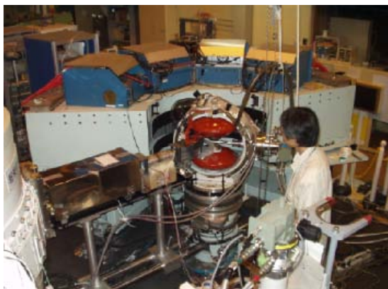
図9 HERMESでの偏極粉末回折実験の様子
