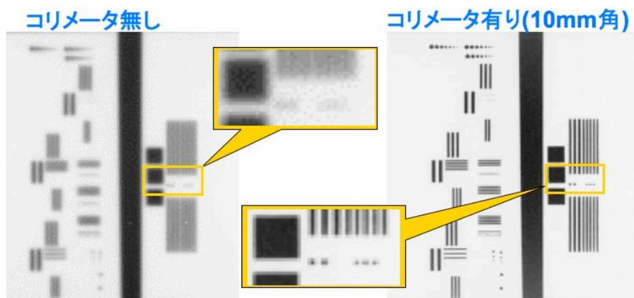
図6 コリメータの有無による中性子透過画像解像度の比較.
