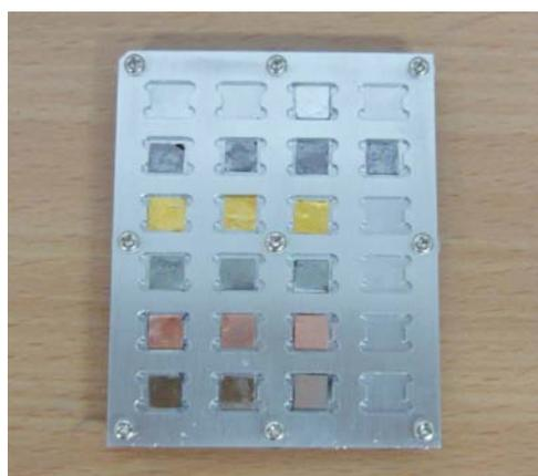
図7 共鳴吸収イメージング実験用の検出器評価のための標準試料. 複数の厚さの金属箔 (In, Ta, Au, Cu, Cu/Mn 合金) が、アルミニウム製ホルダーに収められている。
