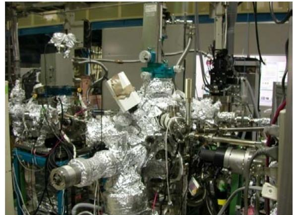
写真 2: 深さ分解 XMCD 測定装置
