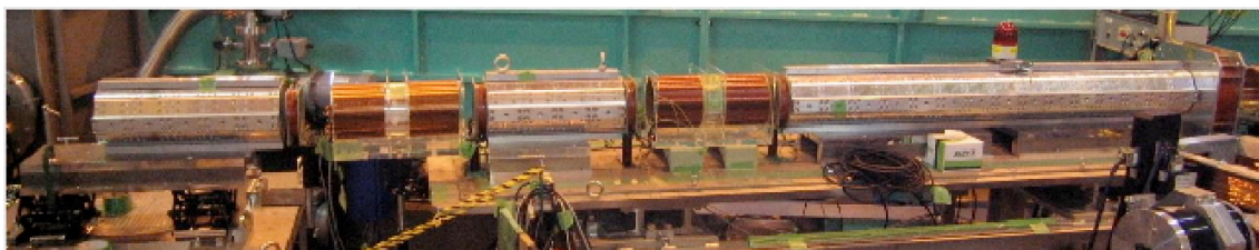
図 2 六極磁石に基づくパルス中性子集光用磁気複合光学系のプロトタイプ機
