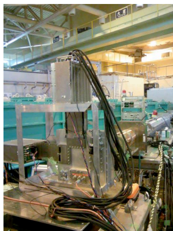
図2: JARR3に設置された \mu PIC 検出器と冷中性子照射で得られた画像。
