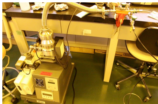
図5 導入した真空ポンプ
