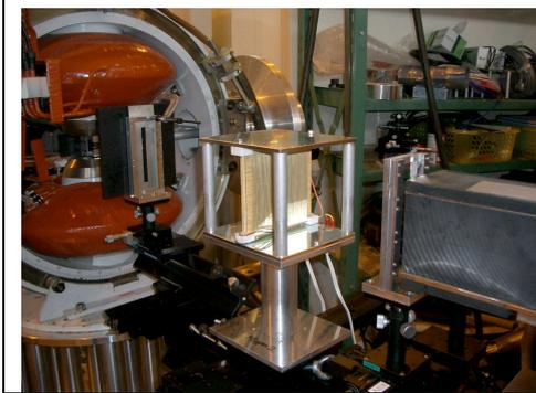
図 1 1 現在、原子炉で利用されている横磁場型スピントリッパー。スピン偏極した中性子の偏極ベクトルの向きをコントロールするデバイスである。このタイプのトリッパーを含め、トリッパーの開発を検討している。
