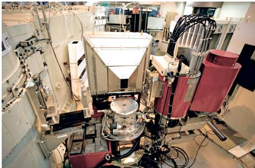
図7 東北大学金属材料研究所所有の三軸型分光器 AKANE。自由度が高く、偏極技術開発に最適の装置である。
