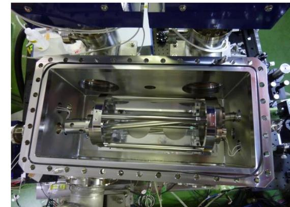
3次元4枚鏡光共振器は完成した。1.3GeV蓄積リング加速器に設置後、23MeV超高輝度ガンマ線生成実験を行った。一昨年、2枚鏡光共振器を使った実験では $2 \times 10^7$  Photons/secが実測された。鏡の反射率を99.7%から99.99%に上げ、衝突点におけるLaser waist sizeを $30 \mu\text{m}$ から $15 \mu\text{m}$ に絞った。2000倍のガンマ線強度増大と円偏光選択が高速で行えるのが特徴である。
